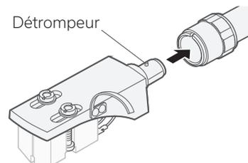
**2** Tournez l'écrou de verrouillage dans le sens de la flèche pour fixer la tête de lecture.
